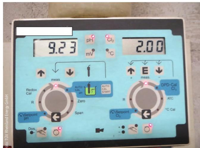
Abbildung 2: Kontinuierliche Messung des Redox-Potentials von Nutzwasser für eine bedarfsabhängige und automatisierte Biozidzugabe.
